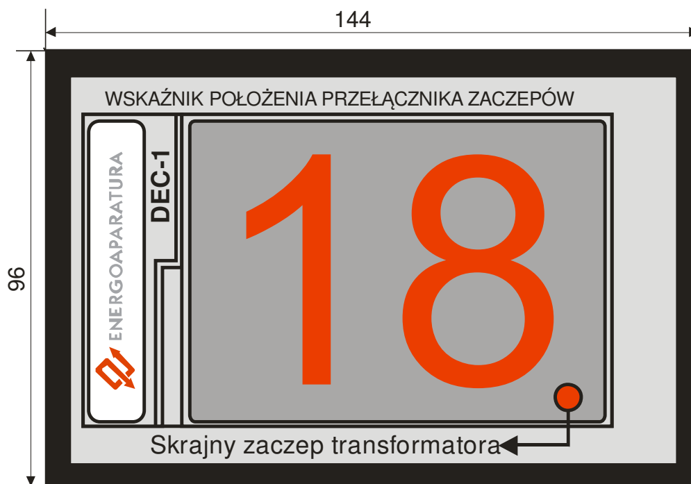
Rys. 1 Wymiary zewnętrzne wskaźnika położenia przełącznika zaczepek
